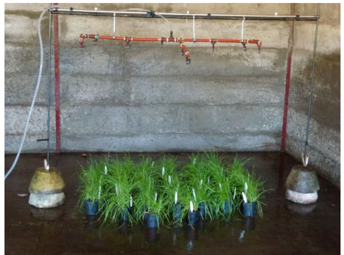
Figura 3. Simulación de un evento de lluvia sobre plantas de raigrás anual ( Lolium multiflorum Lam.) realizado en un predio bajo resguardo de la Estación Experimental Agropecuaria INTA de Balcarce.
