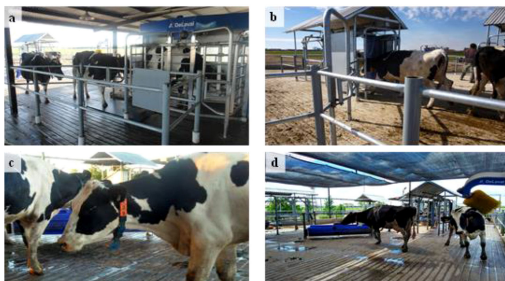
Figura 2. Robot ordeñador en vista frontal (a), con una vaca en ordeño y otras dos que esperan para poder ingresar. Las tranqueras inteligentes (b) poseen antenas y sensores que facilitan el movimiento voluntario de los animales por los diferentes sectores. Las tranqueras y el robot identifican a los animales mediante collares electrónicos (c). En el corral de espera o área de preordeño (d), los animales pueden disponer de media sombra, bebederos, y cepillos rascadores que contribuyen al confort animal.
