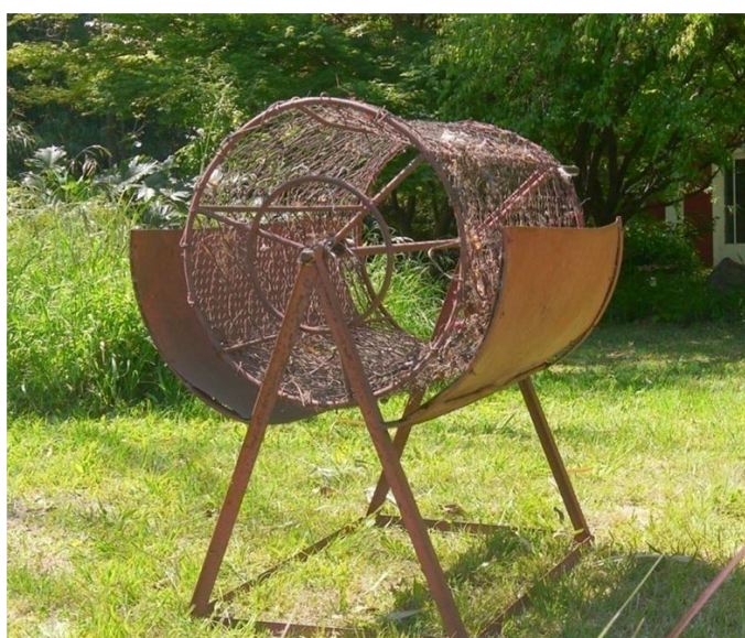
Figura 4. Zaranda giratoria para el tratamiento final del "compost", construida hacia 1995 por Juan José Valla. Jardín Botánico de la Facultad de Agronomía, octubre de 2021. Fotógrafo: D. Medan.
